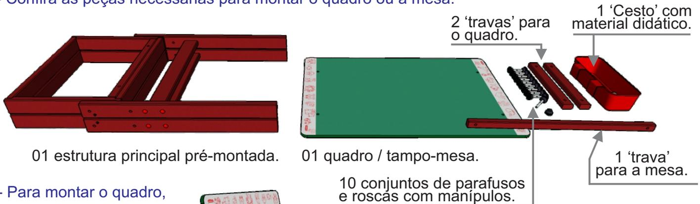
2- Para montar o quadro, mantenha a estrutura principal 'esticada', abra em um ângulo suficiente para fixar as 'travas' nas laterais e fixe-as e o quadro como na imagem.
