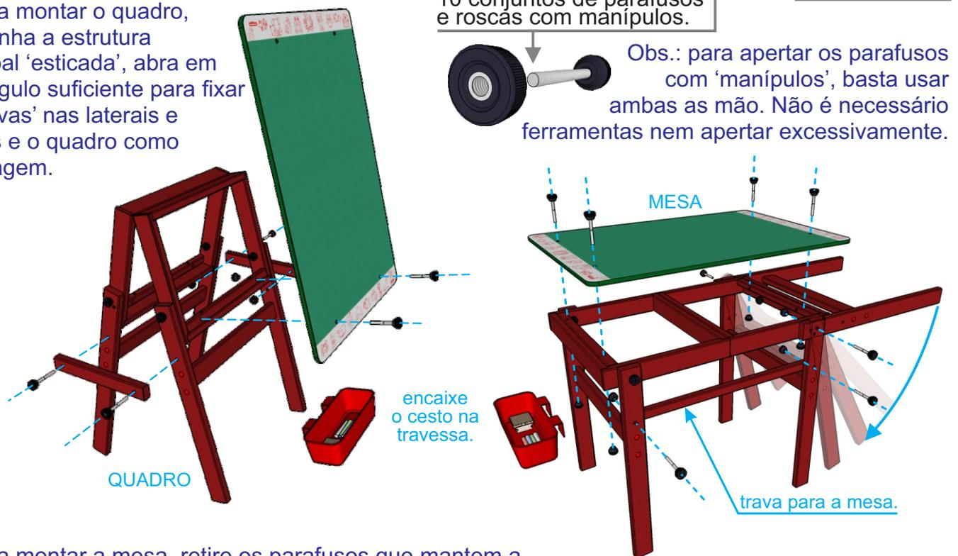
3- Para montar a mesa, retire os parafusos que mantêm a estrutura principal 'esticada', articule (gire) os 'pés' em um ângulo de 90° e recoloque os parafusos. Depois fixe a 'trava' e o quadro (como tampo, com 4 parafusos).
